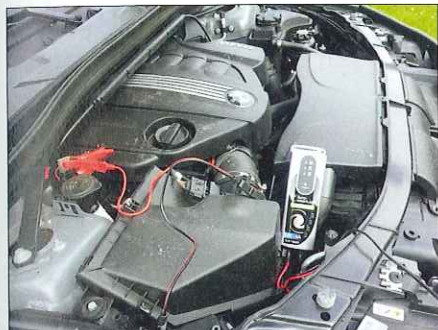
Accu-Smart chargeant une batterie de voiture.
