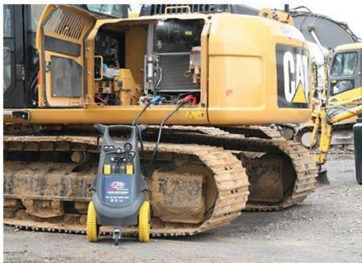
Les stations Propulstation sont conçues pour le dépannage des véhicules de chantier et poids lourds. La conception sur grandes roues leur permet le déplacement sur tous les terrains, au plus près du véhicule. Plusieurs niveaux de puissance sont proposés ainsi que deux modèles bitension pour véhicules de 12 V et 24 V.
